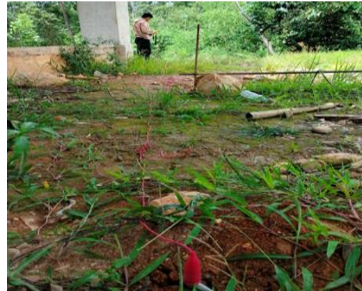
Gambar 3. Proses pengambilan data serta pengaturan jarak elektroda bantu dengan elektroda utama
