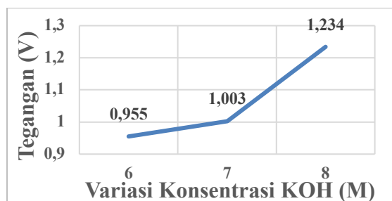
Gambar 2. Grafik Nilai Tegangan Superkapasitor Pada Variasi Konsentrasi KOH 6 M, 7 M, dan 8 M
