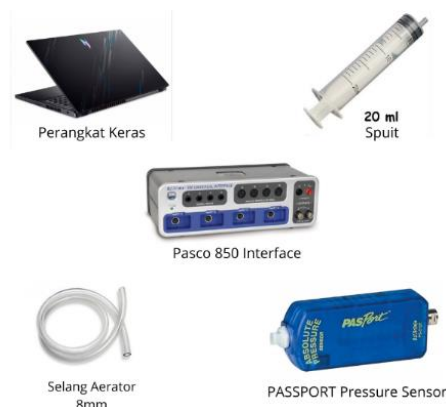
Gambar 1. Alat dan bahan eksperimen tekanan–volume gas
