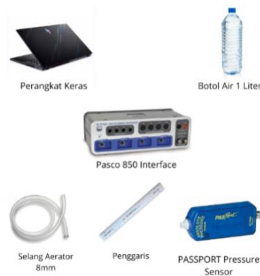
Gambar 5. Alat dan bahan eksperimen tekanan–kedalaman cairan
