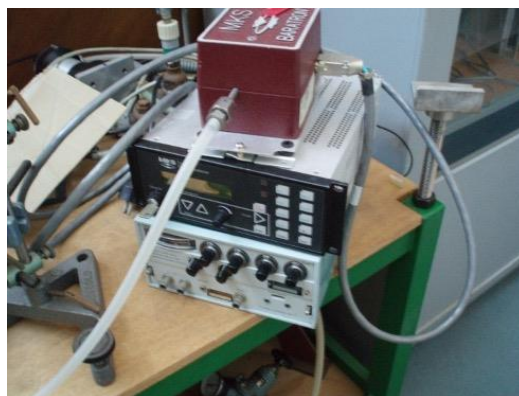
Gambar 3. Sensor tekanan (Baratron) dan transduser tekanan MKS.
