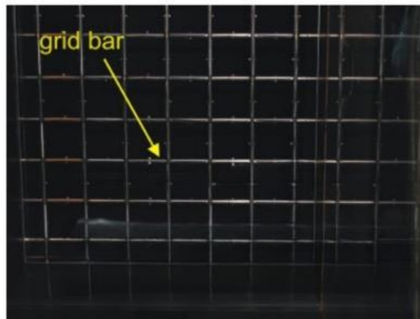
Gambar 2. Grid batang dipasang pada bagian awal terowongan angin untuk menghasilkan kondisi aliran turbulen.
