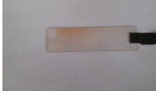
Gambar 3.1. film Sudan III Hasil Evaporasi Vakum.
