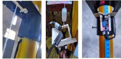
Gambar 4. Empat buah sensor yang sudah dipasang pada pesawat atwood
